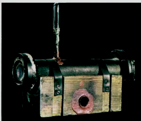
Doc. 1. Appareil utilisé par Chadwick.
